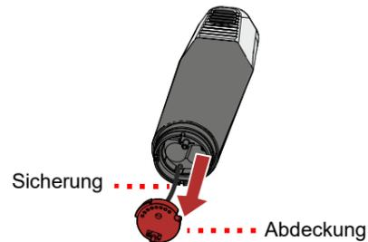
▶ Abdeckung abziehen und loslassen. Die Abdeckung wird von einer Sicherung gehalten.
